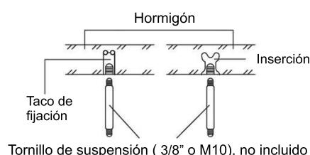
2.2.3 Instale los tornillos de suspensión (utilice tornillos de suspensión W3/8 o M10, 4 piezas) en función del tipo de techo.
