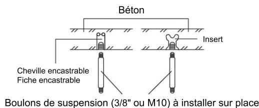
2.2.3 Installez les boulons de suspension (utilisez 4 boulons de suspension de diamètre 3/8" ou M10) en fonction du type de plafond.
