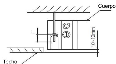
2.3.3 Atornille las tuercas para suspender la unidad. Compruebe que la parte inferior de la unidad interior se encuentra en una posición (10 a 12mm) superior a la superficie inferior del techo. L es aproximadamente la mitad de la longitud de tornillo del gancho de instalación.
