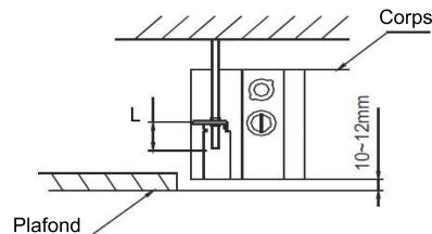
2.3.3 Vissez les écrous pour suspendre l'appareil. Vérifiez que le côté inférieur de l'unité intérieure se situe plus haut (10 à 12 mm) que la surface inférieure du plafond. L fait environ la moitié de la longueur de la vis de l'accroche d'installation.
