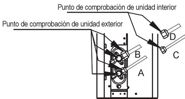
A: Válvula de detención de presión baja
