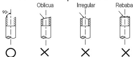
4.1.2 Utilice una fresa para eliminar las rebabas con la superficie de corte hacia abajo para que las virutas no entren en la tubería.
