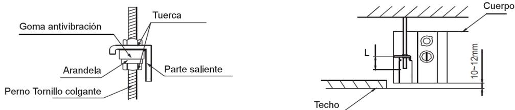
2.3.3 Atornille las tuercas para suspender la unidad. Compruebe que la parte inferior de la unidad interior se encuentra en una posición (10 a 12mm) superior a la superficie inferior del techo. L es aproximadamente la mitad de la longitud de tornillo del gancho de instalación.
