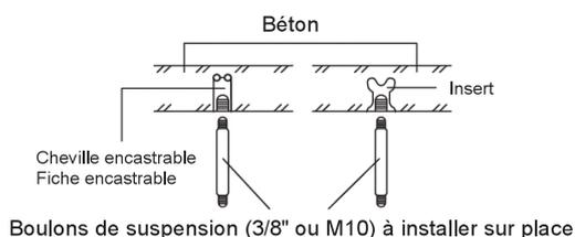
2.2.3 Installez les boulons de suspension (utilisez 4 boulons de suspension de diamètre 3/8" ou M10) en fonction du type de plafond.
