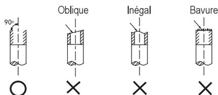
4.1.2 Utilisez un alésoir pour éliminer les bavures, avec la surface de coupe vers le bas afin que les particules ne pénètrent pas dans le tuyau.
