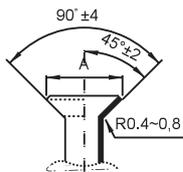
4.1.4 Compruebe si el abocardado se ha realizado correctamente. Consulte a continuación los ejemplos de tuberías incorrectamente abocardadas.
