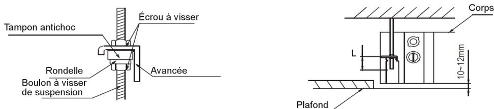
2.3.3 Vissez les écrous pour suspendre l'appareil. Vérifiez que le côté inférieur de l'unité intérieure se situe plus haut (10 à 12 mm) que la surface inférieure du plafond. L fait environ la moitié de la longueur de la vis de l'accroche d'installation.
