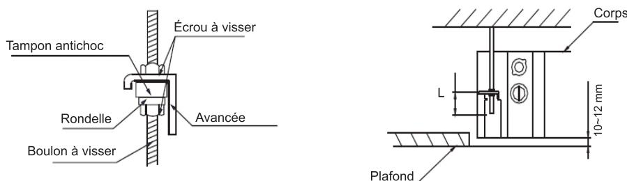
2.3.3 Vissez les écrous pour suspendre l'appareil. Vérifiez que le côté inférieur de l'unité intérieure se situe plus haut (10 à 12 mm) que la surface inférieure du plafond. Cela fait environ la moitié de la longueur de la vis de l'accroche d'installation.
