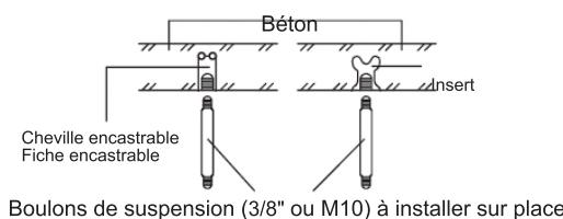
2.2.3 Installez les boulons de suspension (utilisez 4 boulons de suspension de diamètre 3/8" ou M10) en fonction du type de plafond.
