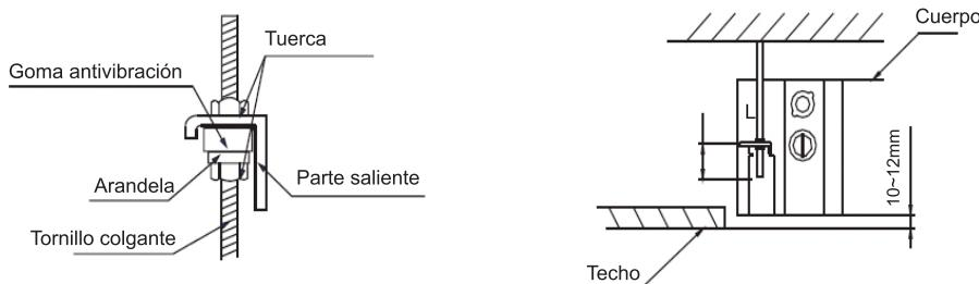
2.3.3 Atornille las tuercas para suspender la unidad. Compruebe que la parte inferior de la unidad interior se encuentra en una posición (10 a 12 mm) superior a la superficie inferior del techo. Es aproximadamente la mitad de la longitud de tornillo del gancho de instalación.
