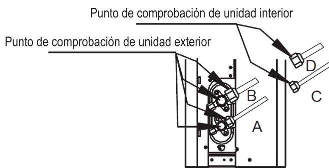
A: Válvula de detención de presión baja      B: Válvula de detención de presión alta
